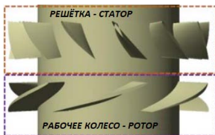
Рис. 11: Принцип передачи количества движения с решётки на лопасти рабочего колеса
